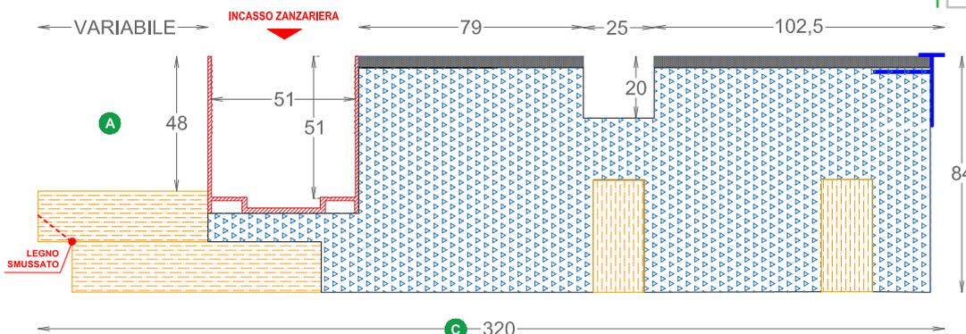
Pannello in XPS e Fibrocemento da 4 mm.
